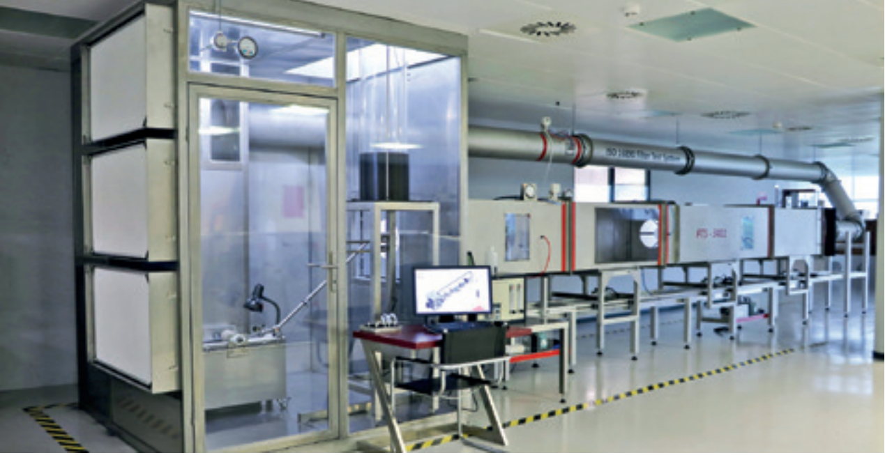
ISO 16890 Test Sistemi - FTS 3401
