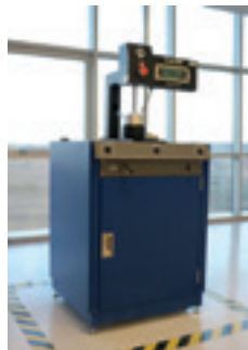
Filtre Medya Test Sistemi FMT 102
