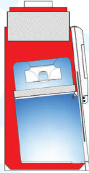
Kontamine çalışma alanını negatif basınçlı tutan plenum çevreleme ve sıfır kaçak üretim teknolojisi
