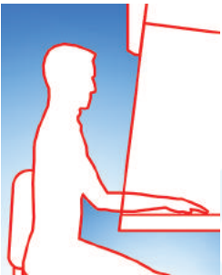
Uzun süreli çalışmaya uygun ergonomi, artan görüş açısı ve operasyon konforu sağlayan, antropometrik kurallara göre tasarlanmış eğimli ön panel
